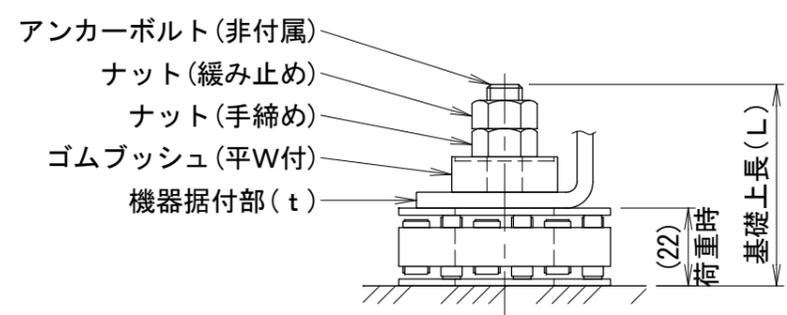
アンカー工法や耐震基準は現場様によります。基礎下の埋め込み深さは先様でご確認ください。
