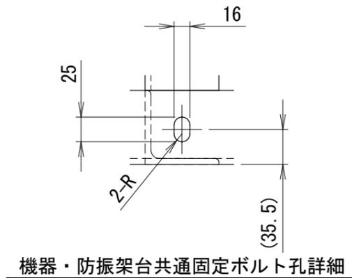
機器・防振架台共通固定ボルト孔詳細
